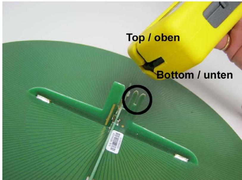
Messgerät senkrecht halten und den Kreuzschlitz an der Stirnseite vorsichtig bis zum Anschlag auf das Halterungskreuz der TCO-Sonde drücken.
