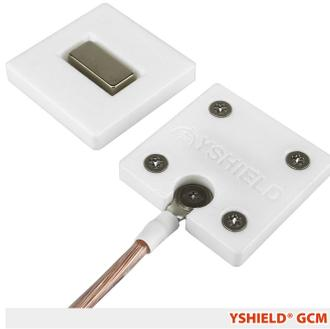
Erdungsanschluss mit zwei Platten die von starken Magneten zusammengehalten werden. Für alle elektrisch leitfähigen Stoffe, Vliese, Gewebe. **Die beiden Anschlussplatten halten magnetisch, das zu erdende Material muss nicht durchbohrt werden.**
