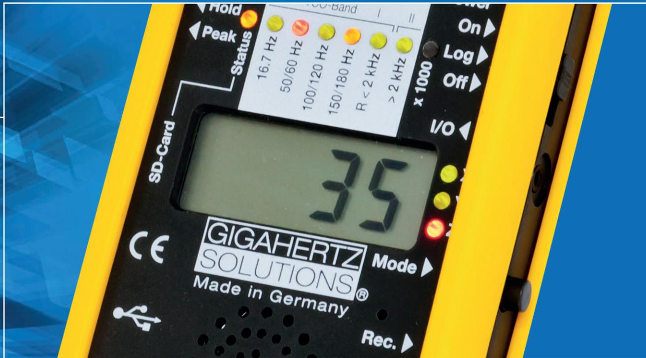
Dreidimensionale Messung des Magnetfeldes mit extrakleinem isotropen Punkt.
